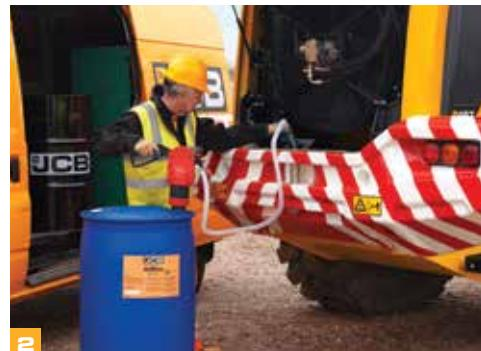
2 Tilgang til diesel- og DEF-tankene (dieseoleksosvæske) er enkel via en låsbar grill bak på maskinen.
