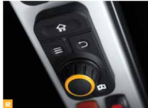
**2** Det er enkelt å bruke maskinens tilpassede menygrensesnitt med en intuitiv rotasjonskontroll for operasjoner.
