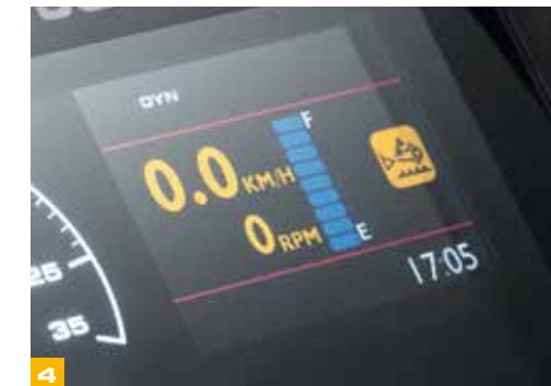
En ny Automatisk avstengning av motoren sparer drivstoff ved å stoppe motoren når maskinen etterlates på tomgang. Tomgangstiden kan stilles av operatøren fra førersetet.
