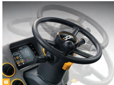
**8** Rattstammen kan vippes frem for enklere ut- og innstigning, uten at den forhåndsinnsilte posisjonen er endret. Rattet vippes enkelt tilbake til den forvalgte posisjonen med et eget håndtak.
